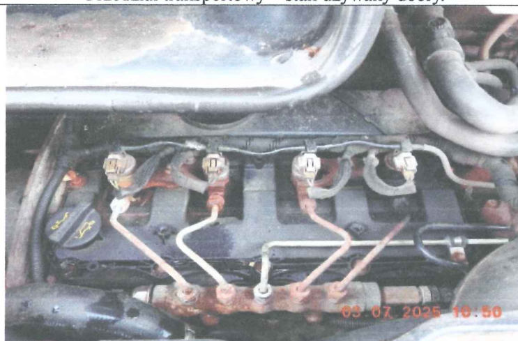
Komora silnika – stan używany, liczne ogniska korozji.
