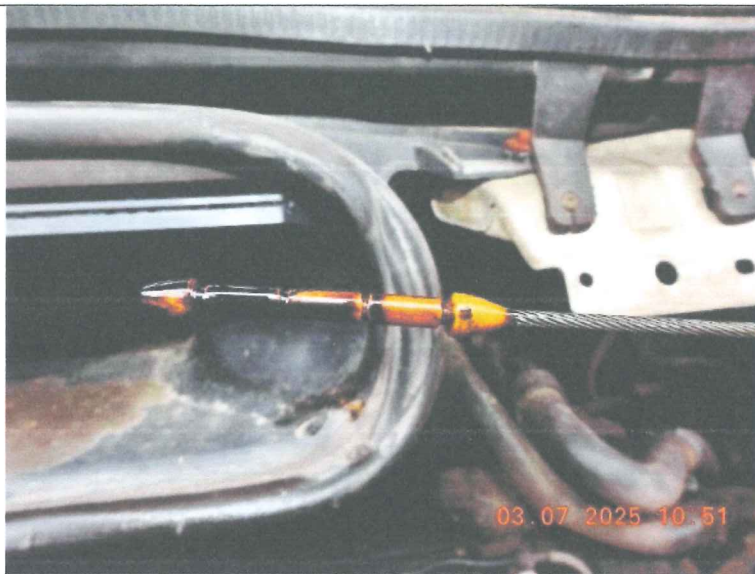
Poziom oleju w silniku stan pośredni.
