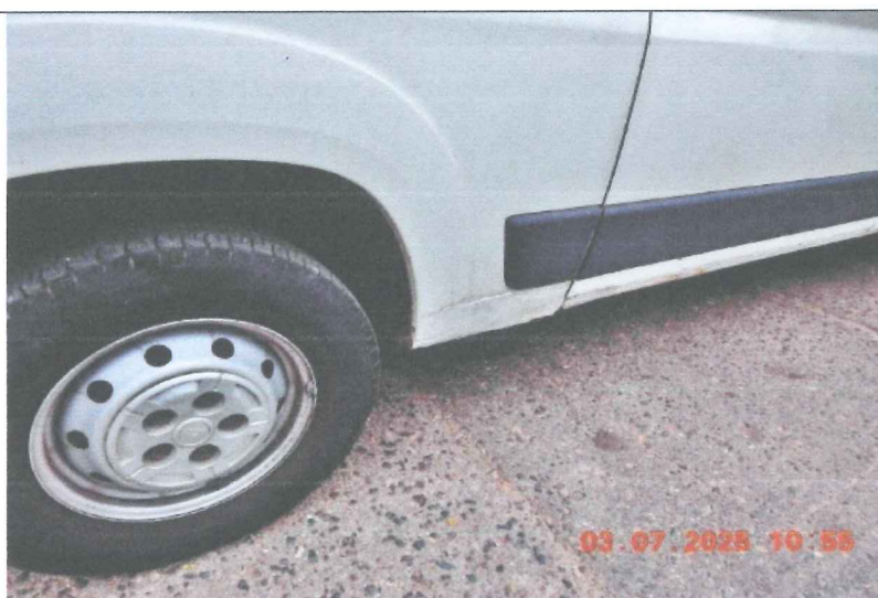
Próg tylny prawy głęboko skorodowany. Widoczne ślady wcześniejszej naprawy.
