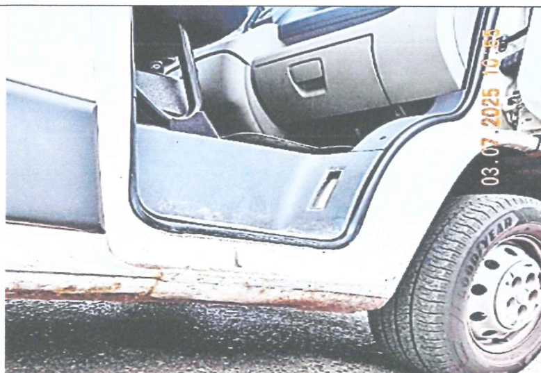
Próg prawy głęboko skorodowany.
