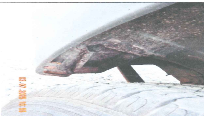
Nadkole tylne prawe, głęboko skorodowane.
