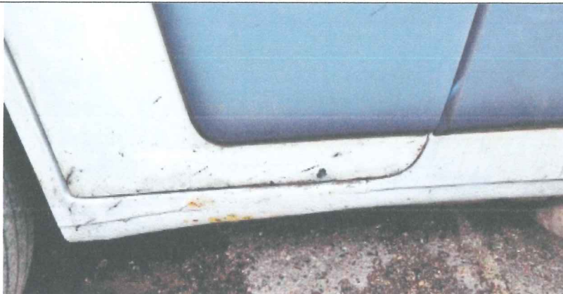
Próg przedni lewy głęboko skorodowany, widoczne ślady wcześniejszej naprawy.
