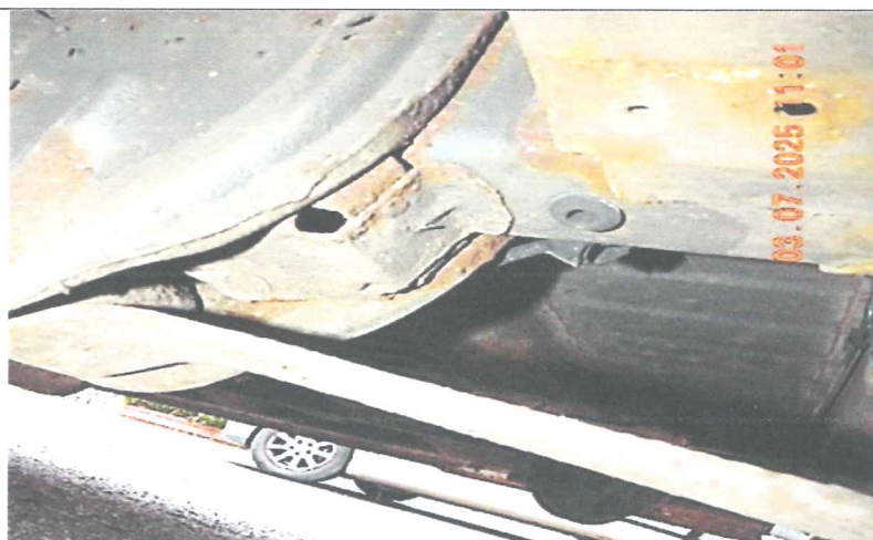
Podwozie głęboko skorodowane.
