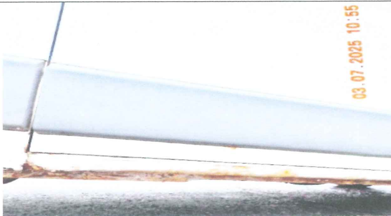
Próg prawy w części środkowej głęboko skorodowany.
