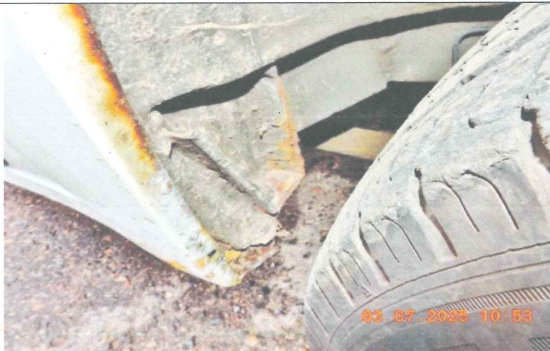
Nadkole przednie prawe, głęboko skorodowane.
