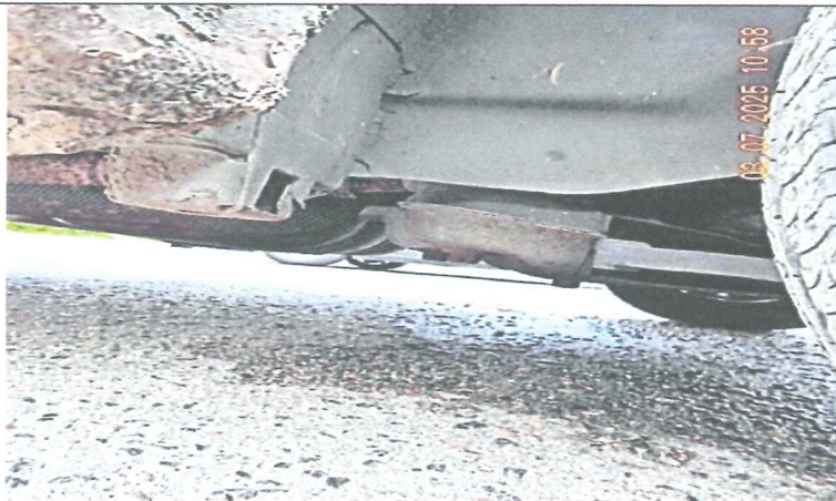
Próg przedni prawy pocięty, głęboko skorodowany.
