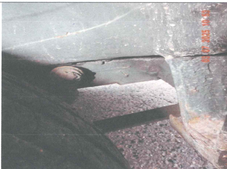
Nadkole przednie lewe, głęboko skorodowane.
