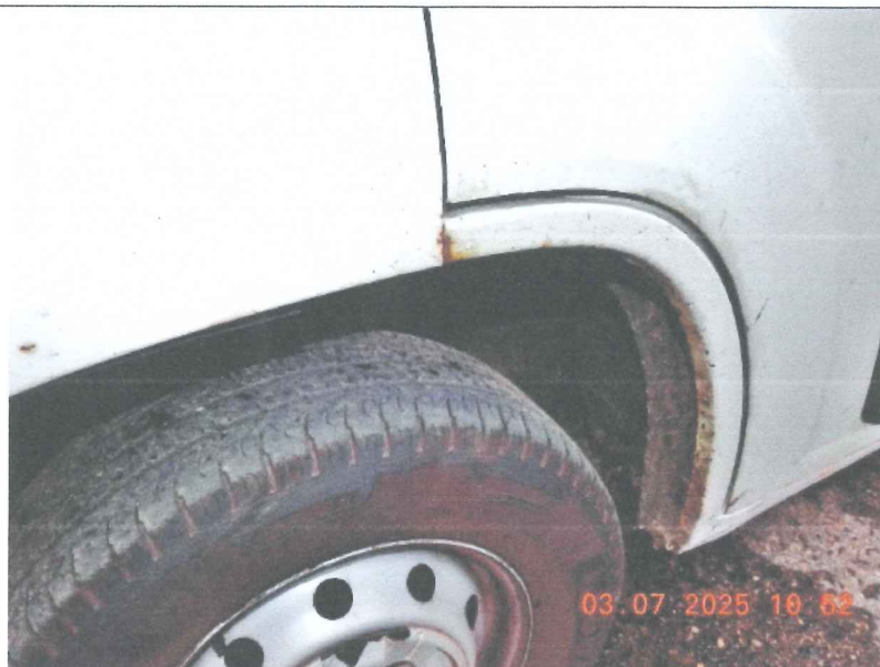
Nadkole przednie lewe, głęboko skorodowane.
