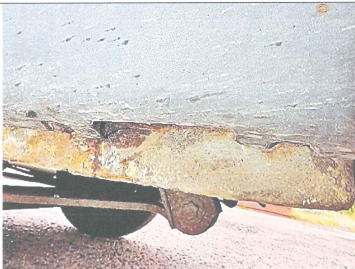
Próg tylny lewy głęboko skorodowany. Wspornik mocowania pióra resoru głęboko skorodowany.
